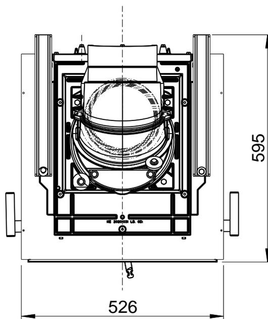
**KALA US** (U-Sicht, mit hochschiebbarer Front), hier: mit/ohne Speicheraufsatz (1004-01133) u. 3-tlg Heizgasstutzen mit Revisionsöffnung (1004-01140) / M1:20
