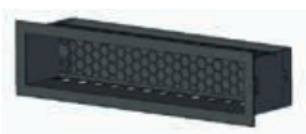
Lämminilmaritilä 200cm 2 Ulkomitta 350x90 mm, Sisämitat 330x70 mm Läpäisyalue 200 cm 2 Musta (058862) Tarkoitettu max 40mm paksulle rakennuslevylle
